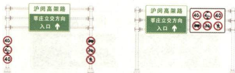
(a) 管理措施悬挂于门架两侧杆件上 (b) 管理措施组合后悬挂于入口门架上方
